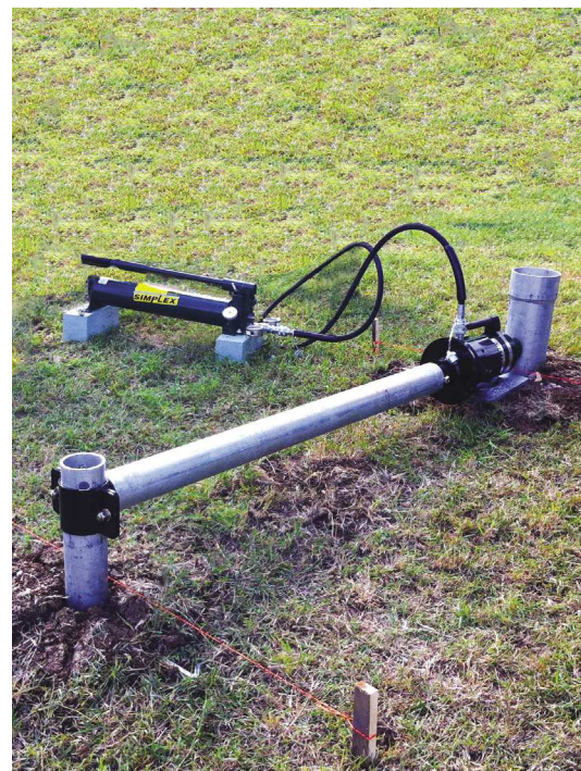
TEST OBCIĄŻENIOWY NA ZGINANIE PAŁA
