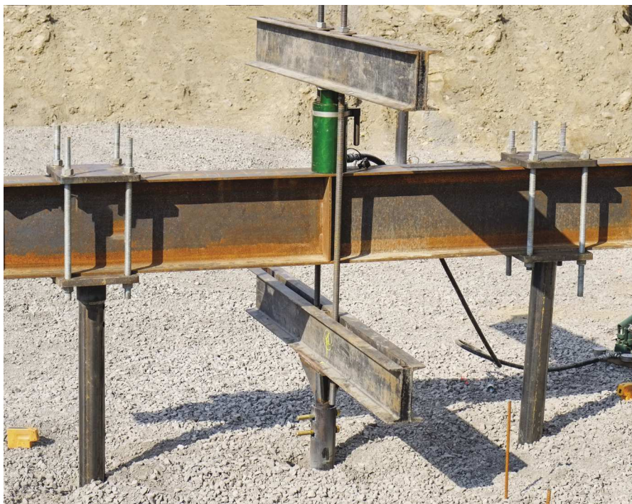
TEST OBCIĄŻENIOWY NA WYCIĄGANIE PAŁA
