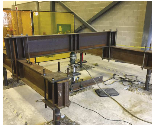
TEST OBCIĄŻENIOWY NOŚNOŚCI PALA
