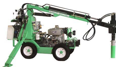
Figure 4 – Machines pour l'installation des TECHNO PIEUX®
